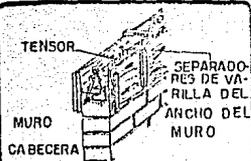
Cimbrado de tensor.- El cimbrado del tensor se fija al muro cabecera mediante amarres de alambre recocido, pasando éste de lado a lado de la cimbra a través de pequeñas perforaciones que se hacen en las juntas de la madera.
