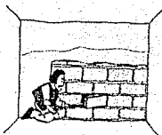
N°2 - Colocar los bloques de bitúmenes sobre el preparado.
