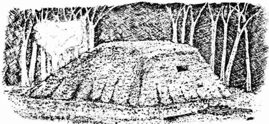
Fig. 4 Horno terminado, el humo escapa por la "cola" del horno y cambia de color según lo avanzado del proceso de carbonización.
