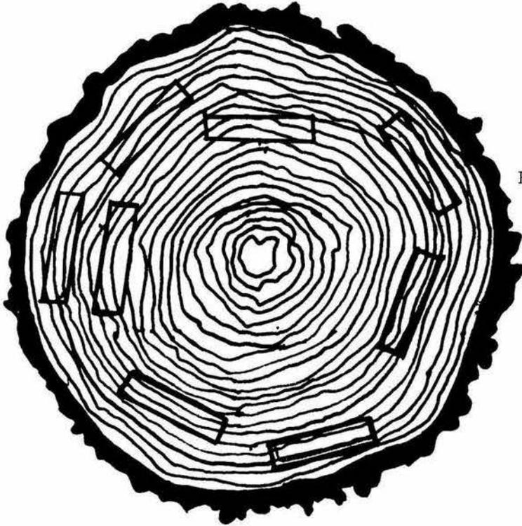
FIG. 5a. Sección transversal del rollete mostrando la orientación y la forma de las probetas para la contracción tangencial
