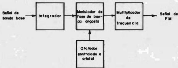
FIG. (III.8) DIAGRAMA A BLOQUES DEL METODO INDIRECTO PARA GENERAR UNA SEÑAL DE FM DE BANDA ANCHA.
