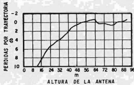
FIG. (II.16) PERDIDA DE PROPAGACION EN FUNCION DE LA ALTURA DE LA ANTENA, ODB CORRESPONDEN A LA PERDIDA EN EL ESPACIO LIBRE.
