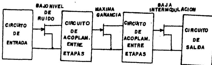
Figura I-c. Diagrama a bloques de un amplificador típico multietapa con FET de microondas.
