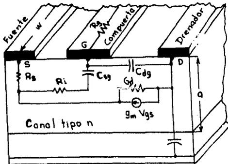
Figura 3-11. Sección de corte de un MESFET.
