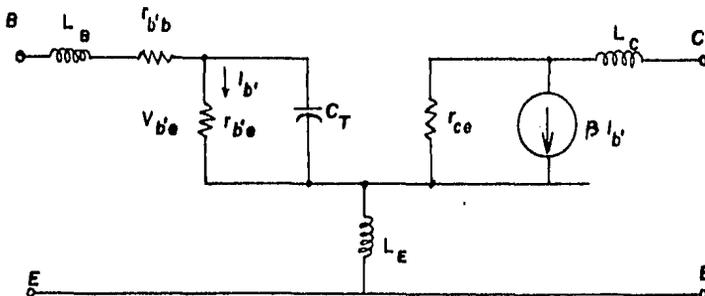
Figura 3-3. Circuito equivalente utilizando el efecto Miller.
