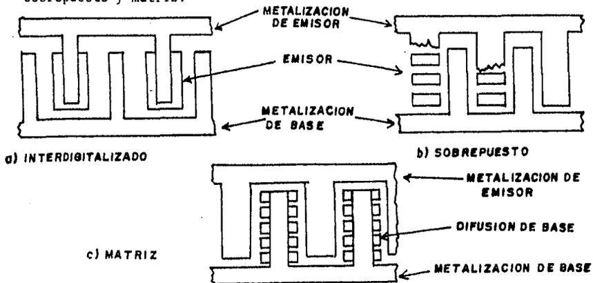
Figura 3-1. Superficies geométricas de transistores de microondas.
