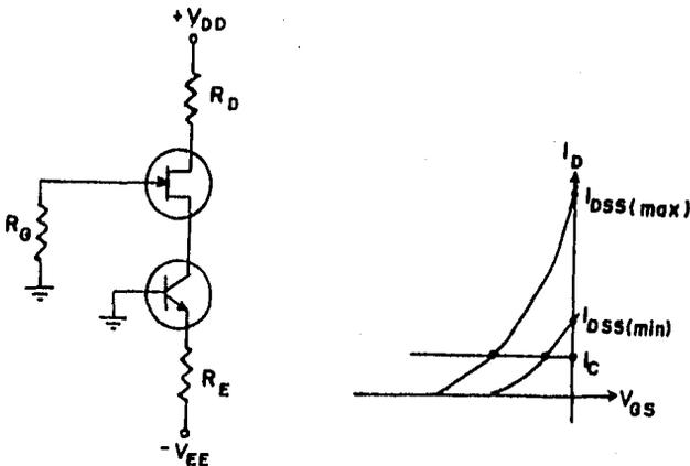
Figura 3-13. Circuito de polarización con dos fuentes.
