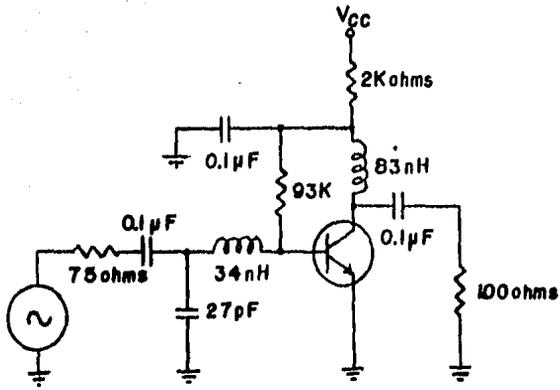
Figura 4-18. Circuito final del ejemplo 4.
