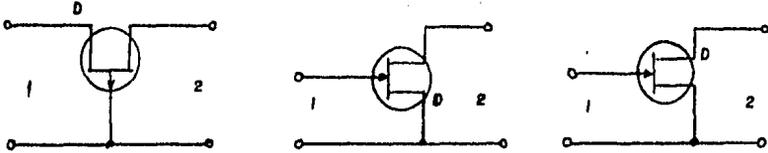
Figura I-b. Diagrama esquemático de tres métodos de conectar un FET.
