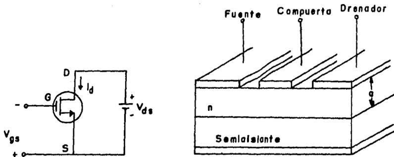
Figura 3-9. Símbolo y diagrama esquemático de un MESFET.
