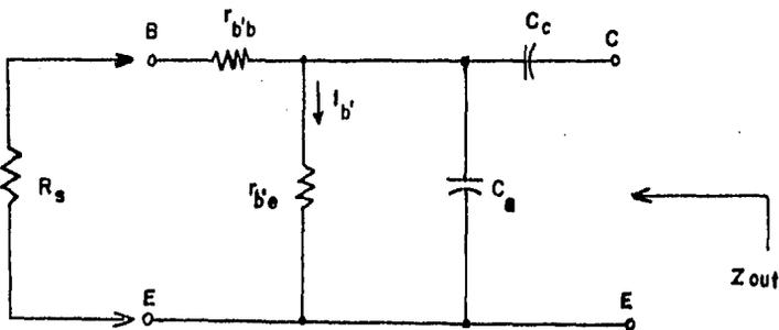
Figura 3-5. Impedancia equivalente de salida.
