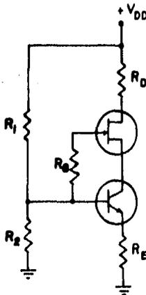
Figura 3-14. Circuito de polarización con una fuente.
