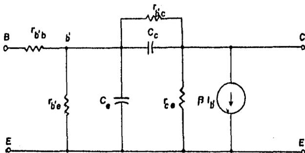
Figura 3-2. Circuito equivalente del transistor en la configuración emisor común.
