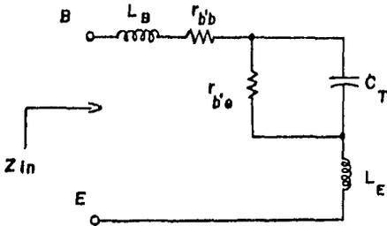
Figura 3-4. Impedancia de entrada equivalente.
