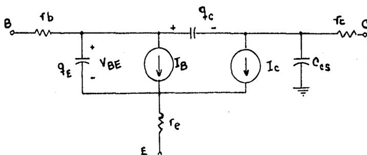
Figura 3-6. Modelo de EBERS-MOLL de un transistor bipolar.
