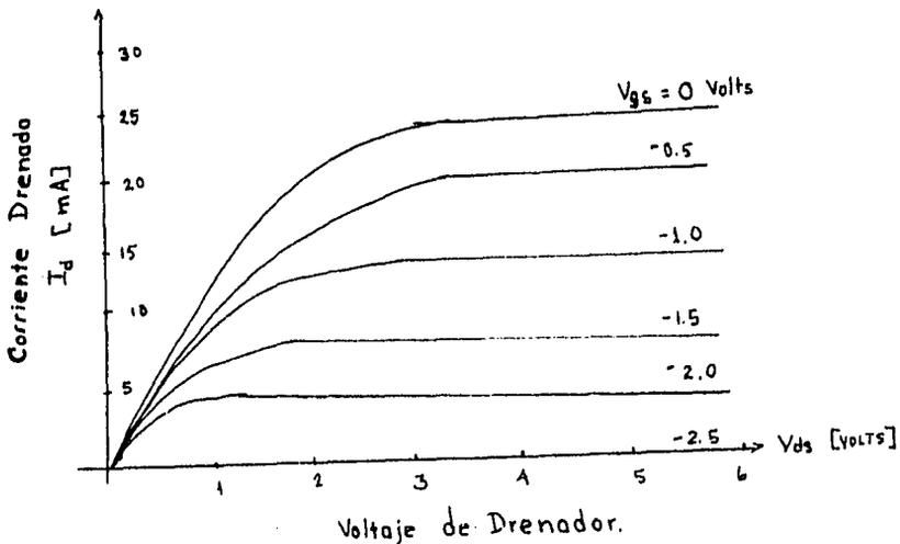
Figura 3-10. Característica de Voltaje de drenador contra Corriente drenada.
