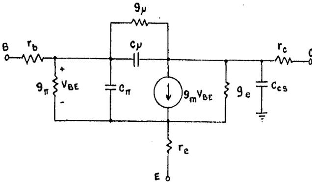
Figura 3-7. Circuito  $\pi$ -híbrido linealizado para un transistor bipolar.
