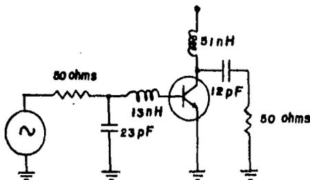
Figura 4-11. Circuito final para el ejemplo 1.
