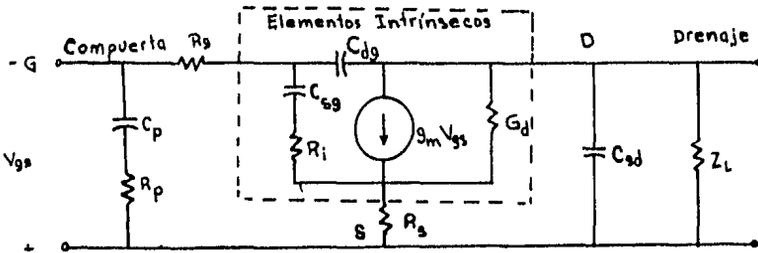
Figura 3-12. Circuito equivalente de un MESFET.
