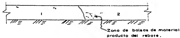
Figura N° V-18. Junta diaria con problemas de balsas de material de rebate.
