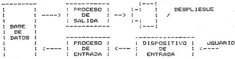
FIG. 1 MODELO SIMPLE DE UN PROCESO INTERACTIVO.
