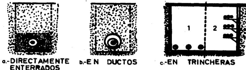
Figura 3.40 Instalación de Conductores.
