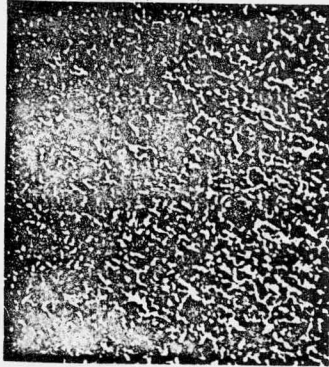
Fig.29 Micrografía electrónica de la transmisión de electrones de la estructura de un revestimiento de \text{Au-MgF}_2 con q=0.3 , d=38.1\text{nm} a una temperatura de 297^\circ\text{C} .
