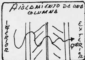
N.- Y segundo, las pérdidas de calor a través de la columna son despreciables.
