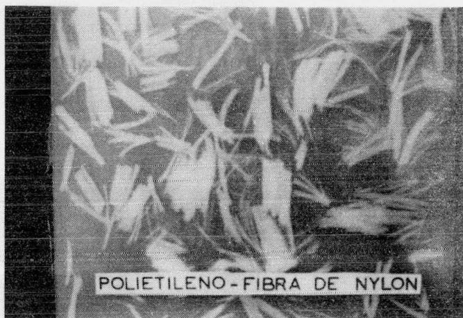
FIGURA 18. MATERIAL COMPUESTO A BASE DE FIBRA DE NYLON Y PLACA DE POLIETILENO.
