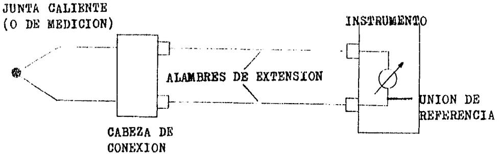
Fig. IV.40 Circuito básico del termopar
