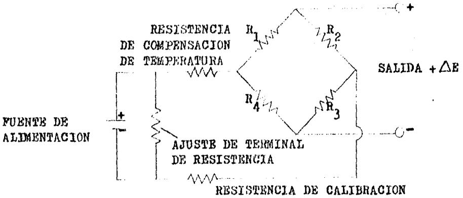
Fig. IV.27 Circuito de puente de Wheatstone para medición de esfuerzos
