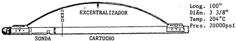
FIG. II-46.- Herramienta de Neutrón Compensado (Schlumberger).
