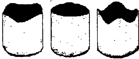
Fig. 15.- Orejas en una pieza obtenida por embutido profundo (14).
