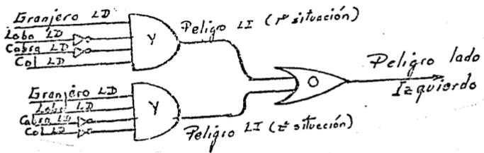
Fig. 41. Combinación de los circuitos Y, O, NO.
