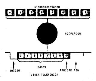
Esto nos dará como resultado una velocidad de recepción de 120 caracteres/segundo a 1200 bauds y una velocidad de transmisión de 7.5 caracteres/segundo a 75 bauds. Recordemos que estas velocidades pueden invertirse para aplicaciones específicas.
