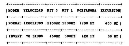
El demodulador contará con un sistema de detección de portadora que le indicará la presencia de la misma si el nivel de recepción es superior a -43 dBm y detectará la ausencia de ésta si el nivel de recepción es inferior a -48 dBm. Además la histerisis sorá siempre superior a 2 dBm. El nivel máximo admisible para la recepción sera de -6 dBm.
