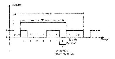
El bit de paridad se agrega a la cadena de caracteres para verificar que la suma de todos los bits con valor l sea siempre par. En caso contrario detectamos un error consistente en la inversión de un bit en la transmisión y solicitamos la retransmisión del caracter.
