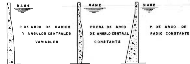
FIG.I. 2.7 TIPOS DE PRESA DE ARCO
