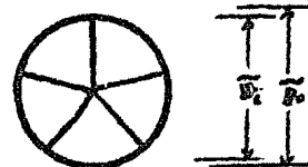
Estrella insertada en un tubo liso.
