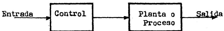
Fig. 1.1 Sistema de control de lazo abierto.
