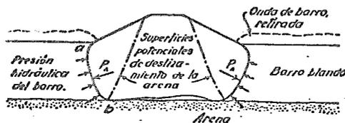
Fig. IV.1 Diagrama que muestra las fuerzas que actúan sobre el suelo en la parte enterrada de un terraplén construido por el método del desplazamiento.
