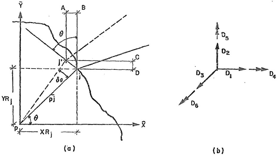
FIG. 3.4 Obtención de la matriz de transformación  $T$  en el caso plano.
