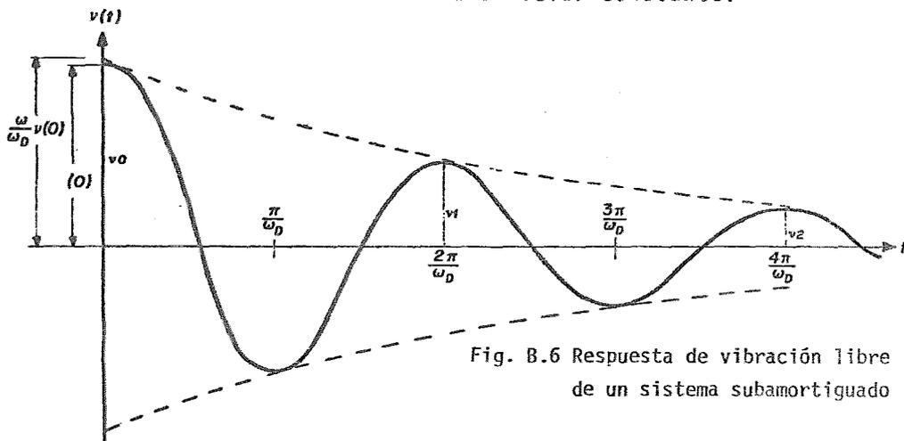
Fig. B.6 Respuesta de vibración libre de un sistema subamortiguado
