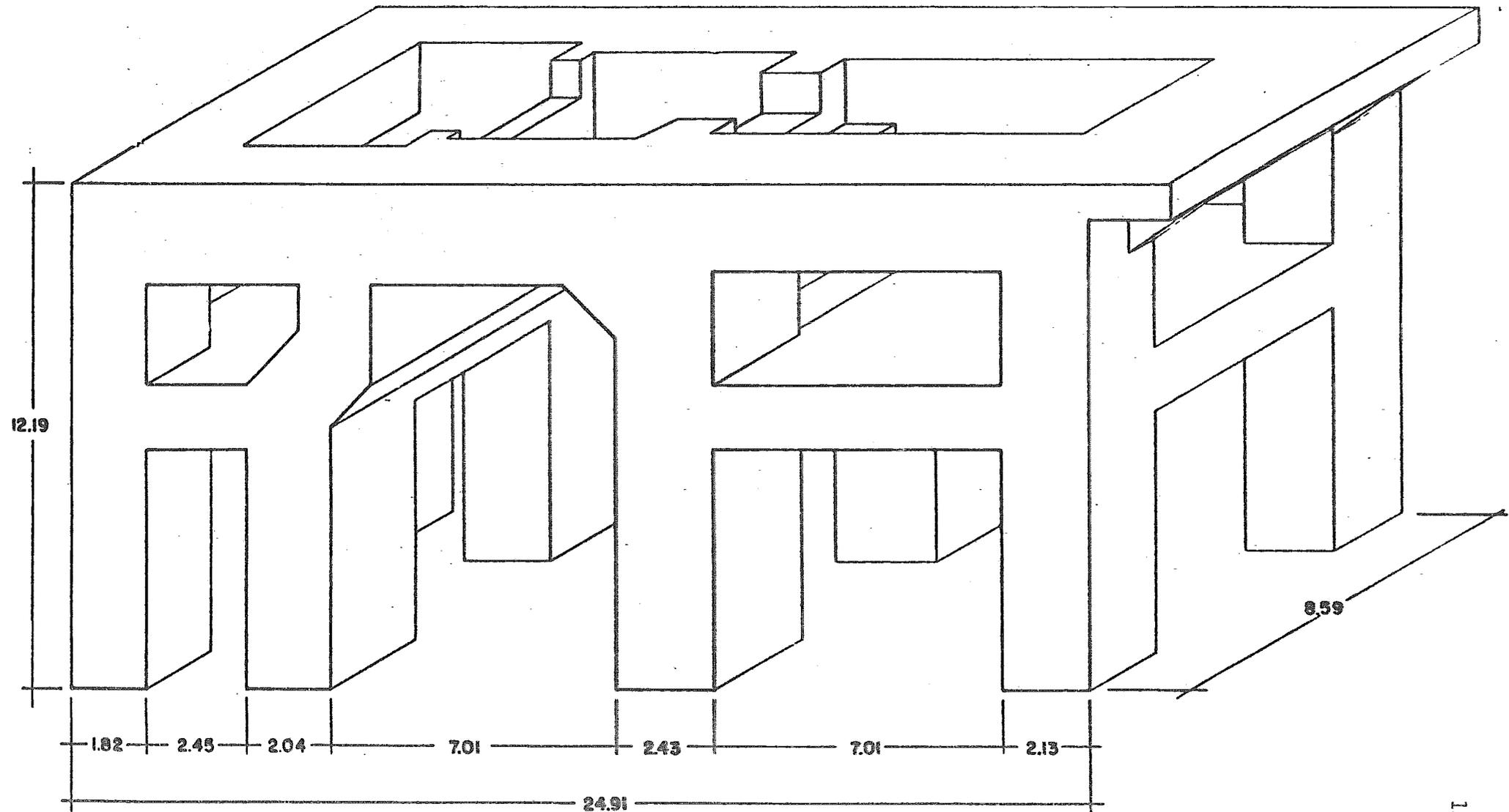
FIG. 3.1 Estructura de apoyo del turbogenerador de la Unidad No.1 de la Planta Termoeléctrica de Valle de México.
