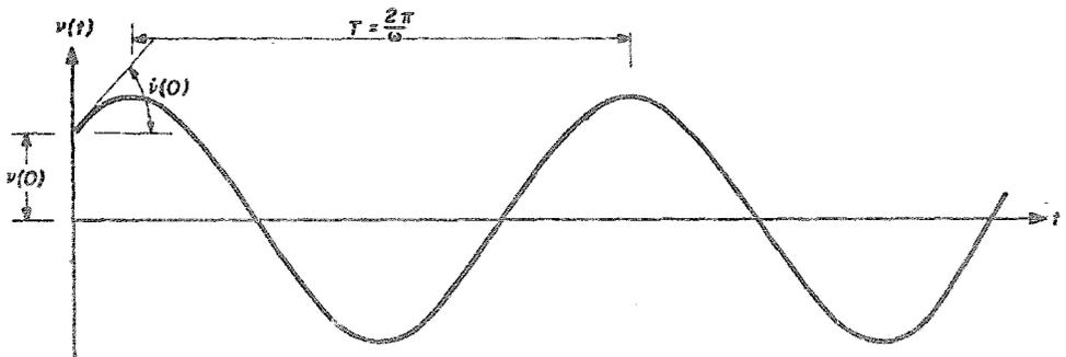
Fig. B.4 Respuesta de vibración libre sin amortiguamiento
