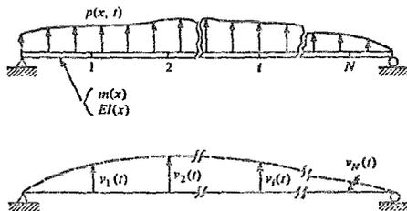
Fig. B.7 Discretización de una estructura general tipo viga.
