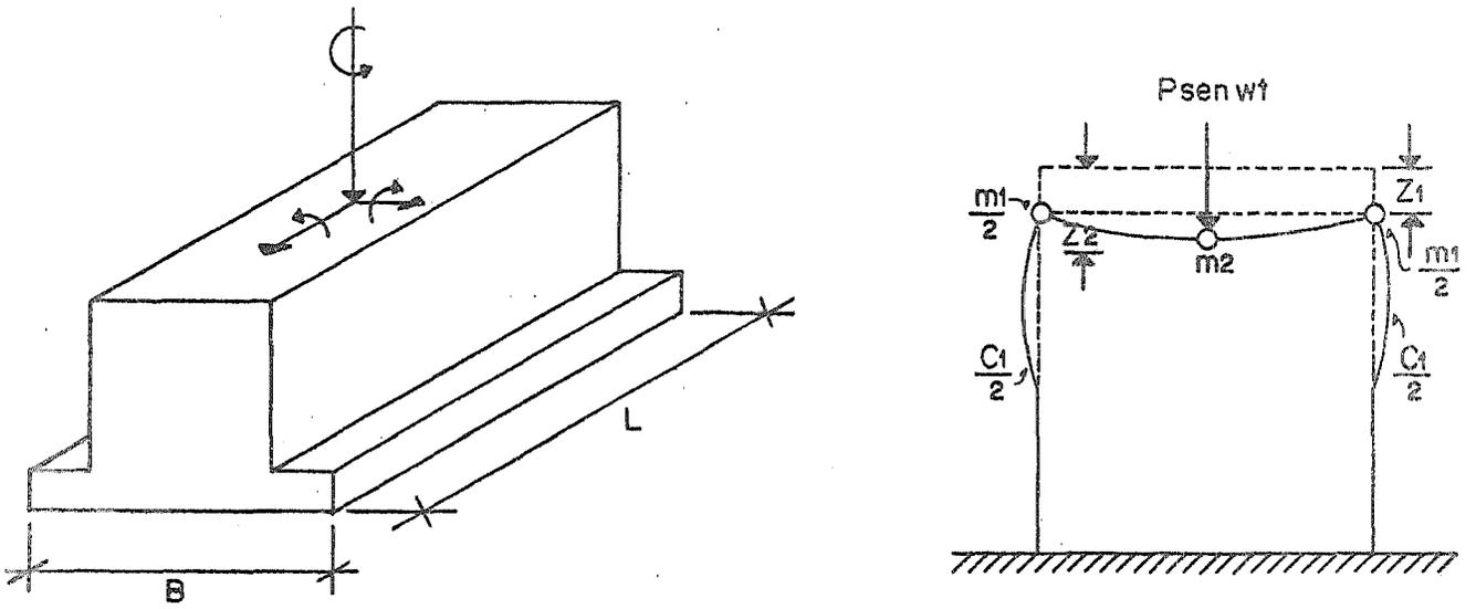
Fig.2.1 Modelos Simplificados de Estructuras de Apoyo para Turbogeneradores.
