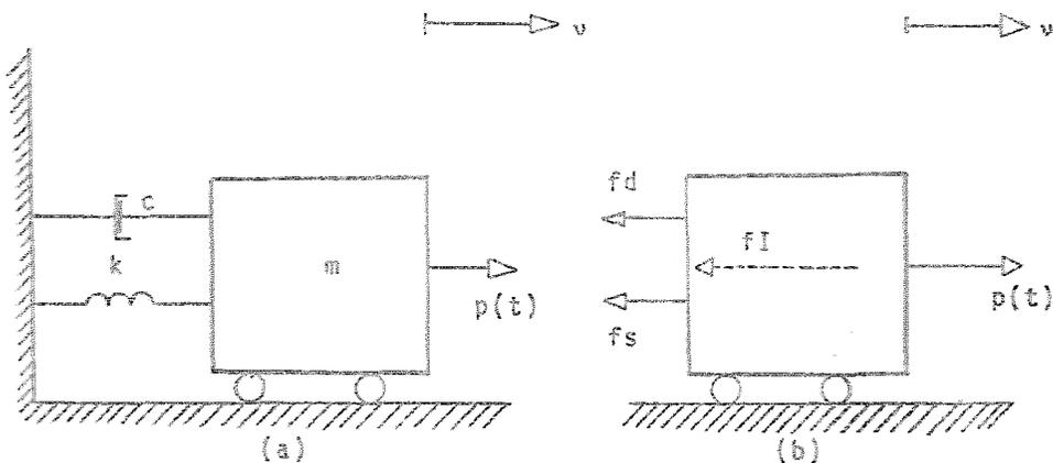
Fig. B.1 Idealización de un sistema de un grado de libertad.
