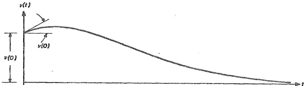
Fig. B.5 Respuesta de vibración libre con amortiguamiento crítico.
