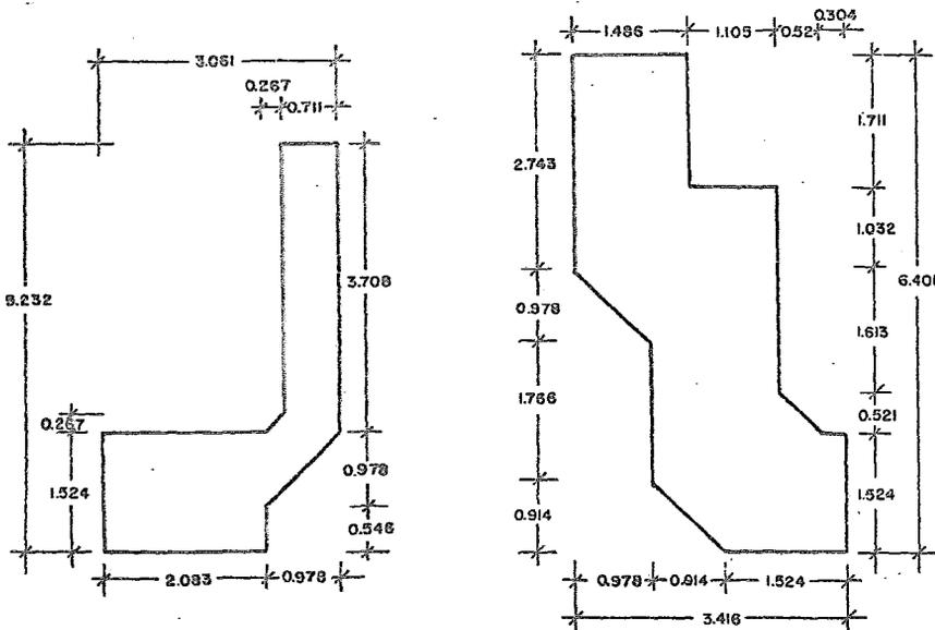
Fig.5.1 Geometría de las Secciones Transversales de los Diafragmas de los Marcos Centrales de la Estructura de la Fig.3.1
