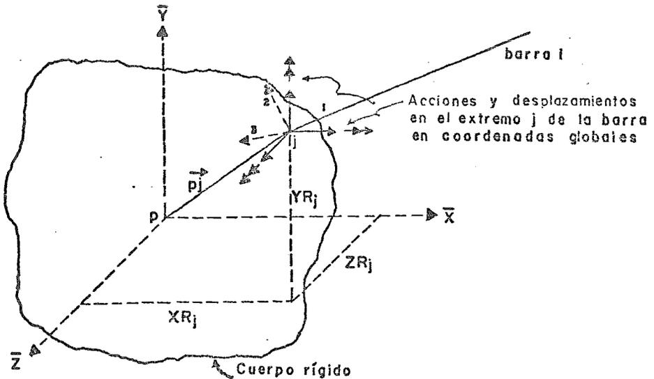
FIG. 3.3 Proyecciones del vector  $\vec{p}_j$  (nudo origen) en coordenadas globales
