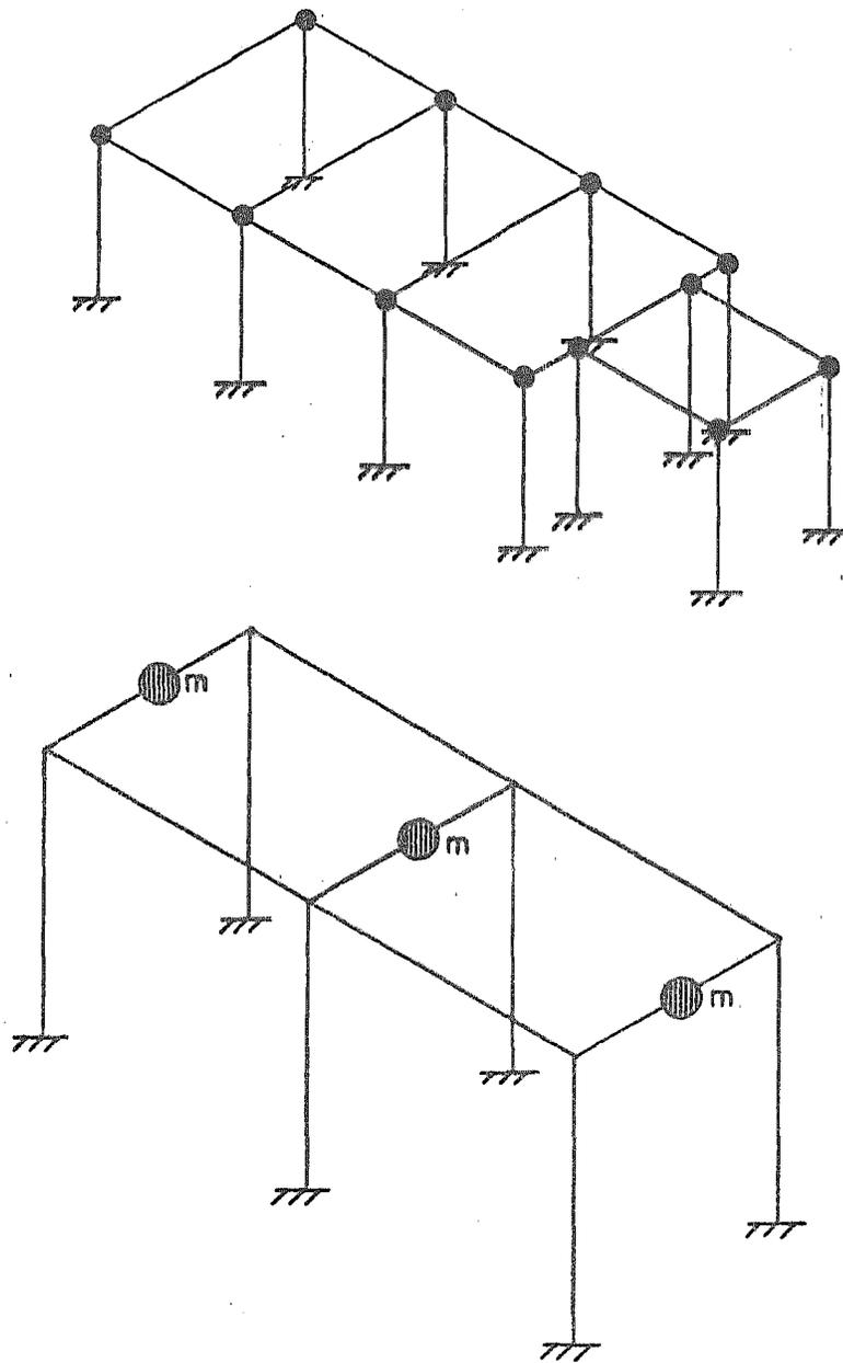
Fig.2.2 Modelos actuales de Estructuras de Soporte para Turbogeneradores.
