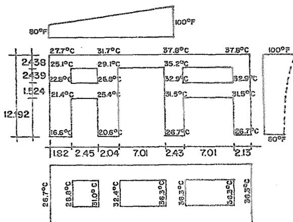
Fig.3.6 Distribución de Temperatura en el Pedestal
