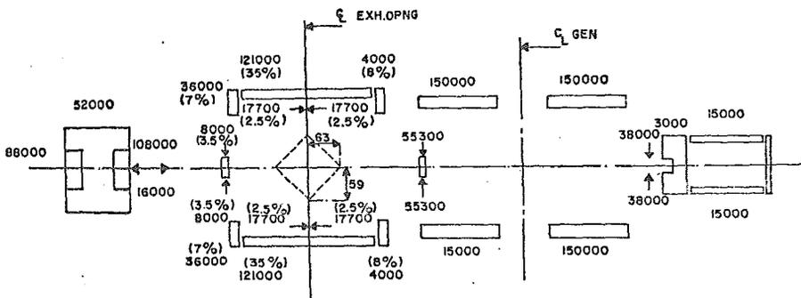
Fig.3.5 Distribución de Cargas en el Nivel de Operación de la Estructura
