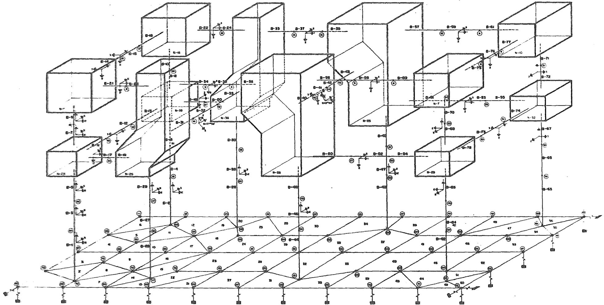
FIG. 5.6 MODELO - 3 DEL PEDESTAL DE LA UNIDAD No. 1 DE LA PLANTA TERMoeLECTRICA WALLE DE MEXICO
