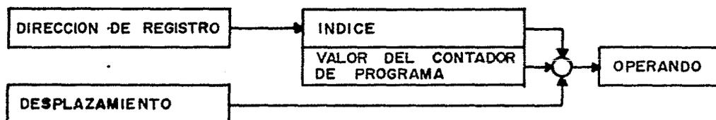
**FIG 58 DIRECCIONAMIENTO RELATIVO AL CONTADOR DE PROGRAMA CON INDICE**
