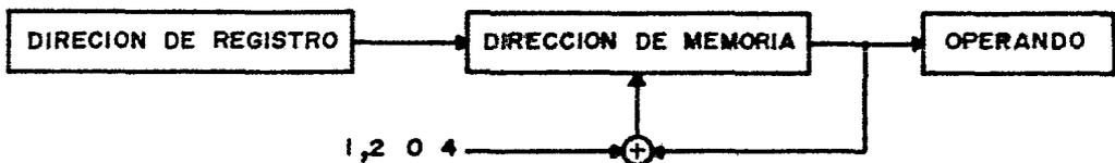
**FIG 51 DIRECCIONAMIENTO INDIRECTO CON POSTINCREMENTO**
