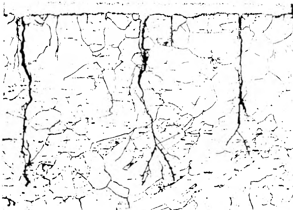
Figura No. 13.- Agrietamiento transcristalino encontrado en un acero inoxidable tipo 304.
