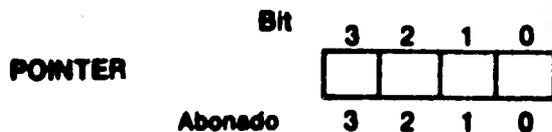
Para recordar el estado anterior del contacto de horquilla de cada abonado se requiere un bit por abonado. Microteléfono colgado = 0 y descolgado = 1. Esta palabra se llama SUBSTATE (Estado del abonado).
