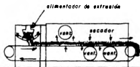
(a) Recorrido del lecho permeable de partículas a través de un secador de circulación transversal de tres unidades.
