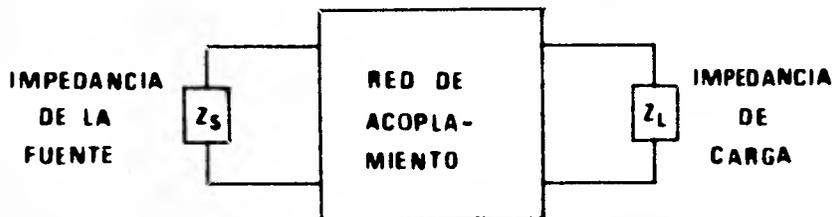
Fig 6 Representación general de las impedancias que intervienen en el diseño de una red de acoplamiento.
