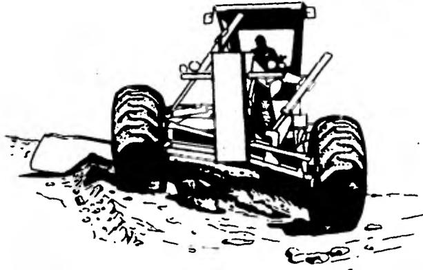
delantera de la máquina hacia un lado, y para remediar esta desviación y oponerse a la fuerza lateral, las ruedas deben inclinarse hacia la dirección que lleve la tierra al correr sobre la hoja. Esta inclinación se logra por medio de un sistema mecánico de piñón y cremallera que actúa directamente sobre las ruedas o también por medio de un sistema hidráulico. Es común que se logren inclinaciones de 22° hacia ambos lados.
