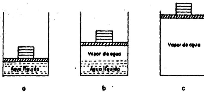
Fig. II.1 Cambio de fase líquida a fase de vapor, a presión -- constante, de una sustancia pura.
