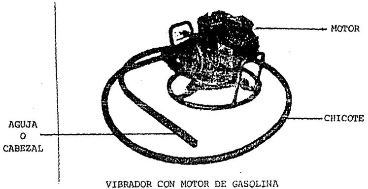
Los vibradores de motor exterior, conectan este con la aguja por medio del chicote. El vibrador es algo más pequeño y menos pesado que los del grupo anterior, lo que permite una mayor facilidad de manejo. Estas máquinas funcionan a base de un motor eléctrico o de gasolina.
