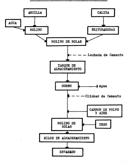
En cualquier proceso de fabricación de cemento la mez cla de materias primas es muy importante y debe realizarse en forma muy cuidadosa, debido a que las reacciones que ocurren en el horno - se producen al fundirse materiales sólidos, por lo cual una mezcla - adecuada del material siempre producirá un producto final de calidad uniforme.
