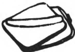
Un chasis es esencialmente una caja plana o chata de madera o metal absolutamente impermeable a la luz, dentro de la cual se coloca debajo de la tapa y en el fondo las dos pantallas reforzadoras, ambas con respaldo elástico a base de fieltro, cuya funci3n es mantener en cierto contacto o ejercer cierta presi3n uniforme contra ambas caras de la pellicula.
