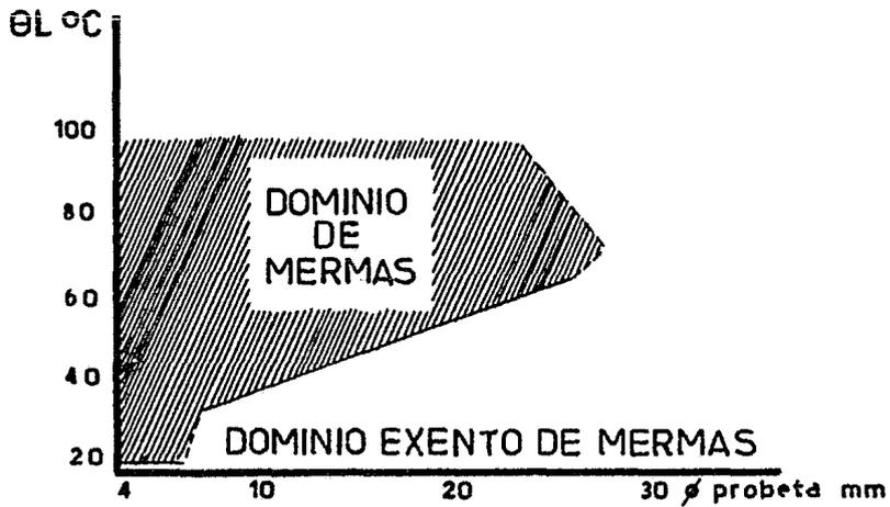
Fig.1\_ Dominio de existencia de mermas de temple en función de la temperatura del agua y del diámetro de la pieza.
