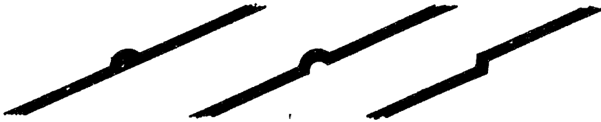
fig. 5.2 Tres tipos de corrugaciones en los conos.
