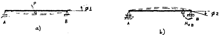
FIGURA IV.49. Giros en el extremo B debidos a: a) Una carga P actuante en el cuerpo de la viga b) Un momento M_B en el extremo A.
