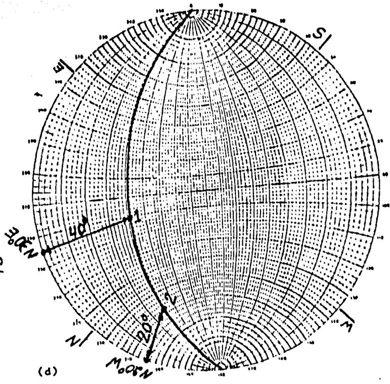
FIG. 4.4. Proyección autocorráfica de 2 líneas y plano común a ambas
