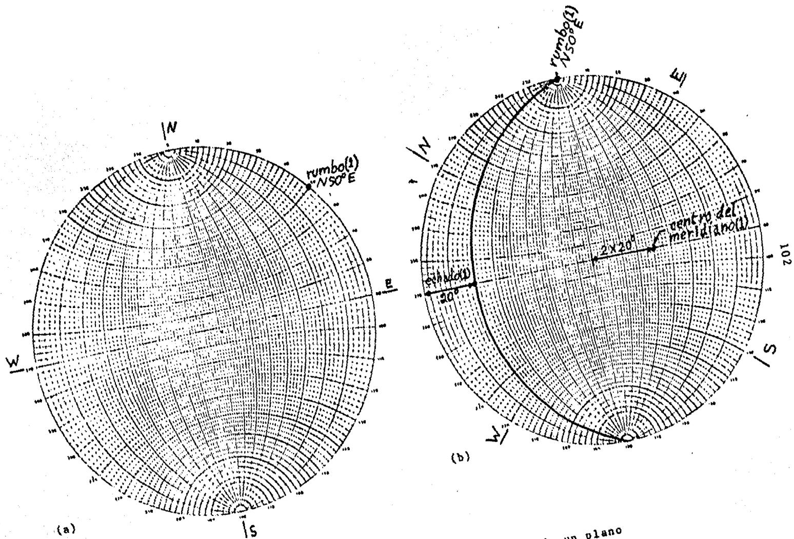
FIG. 4.5. Proyección estereográfica de un plano
