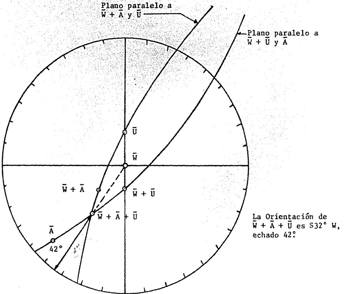
FIG. 4.10. Determinación gráfica de la orientación del vector resultante  $\bar{R} = \bar{W} + \bar{A} + \bar{U}$
