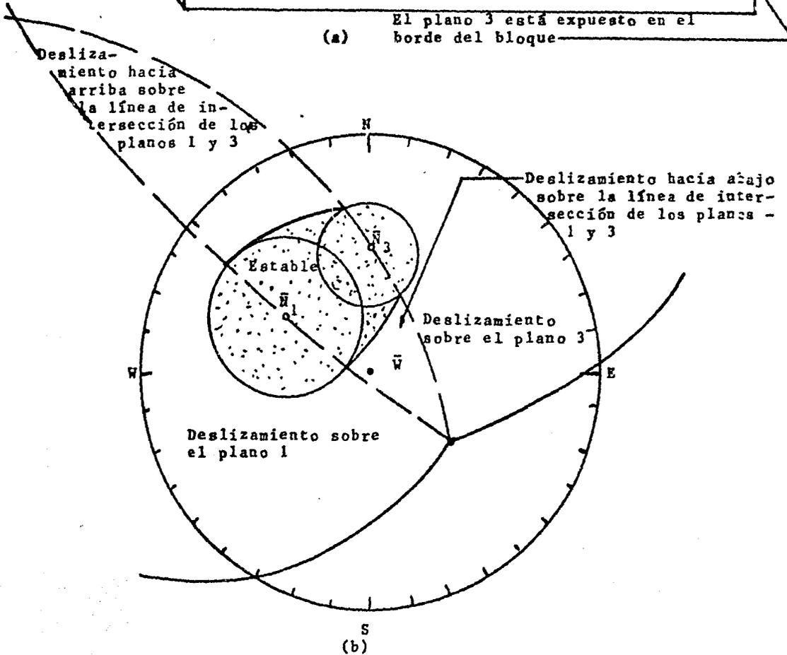
FIG. 4.21 Cuña delimitada por tres planos: plano 3 expuesto en el límite del bloque.
