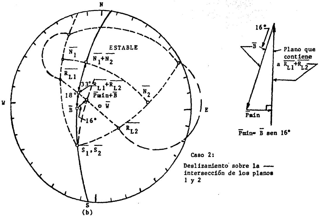
FIG. 4.18 Fuerzas mínimas para estabilizar la cuña de roca.
