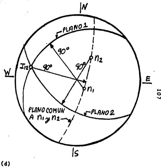
FIG. 4.6. Orientación de la línea de intersección de dos planos.
