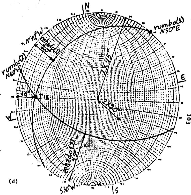
FIG. 4.5. Proyección estereográfica de dos planos y línea de intersección de éstos ( $I_{12}$ )
