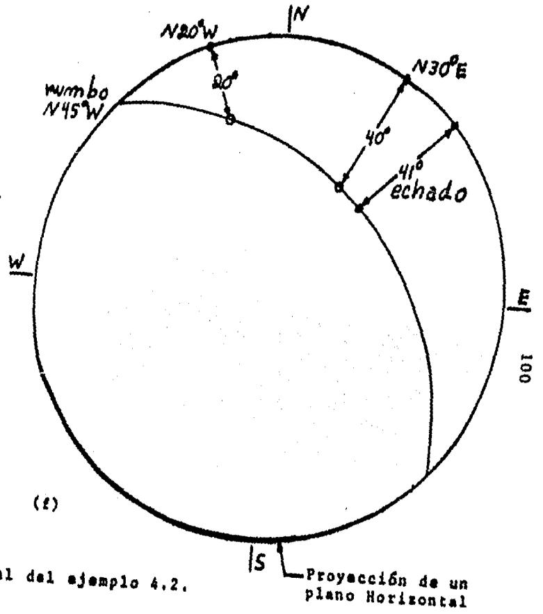
FIG. 4.4. Trazo final del ejemplo 4.2.
