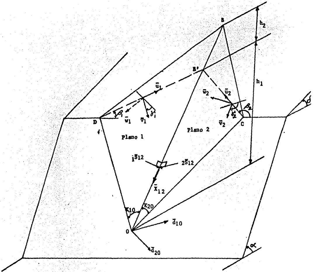
FIG. 3.7 Estabilidad de una cuña de roca delimitada por dos planos de debilidad.
