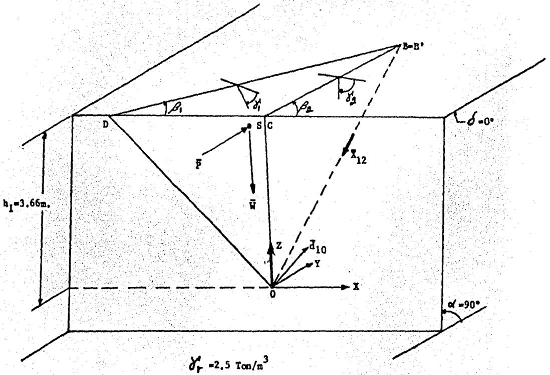
FIG. 3.12 Estabilidad de una cuña de roca delimitada por dos planos de debilidad.
