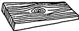
Discontinuidades y alteraciones en la orientación de las fibras producidas por un nudo.
