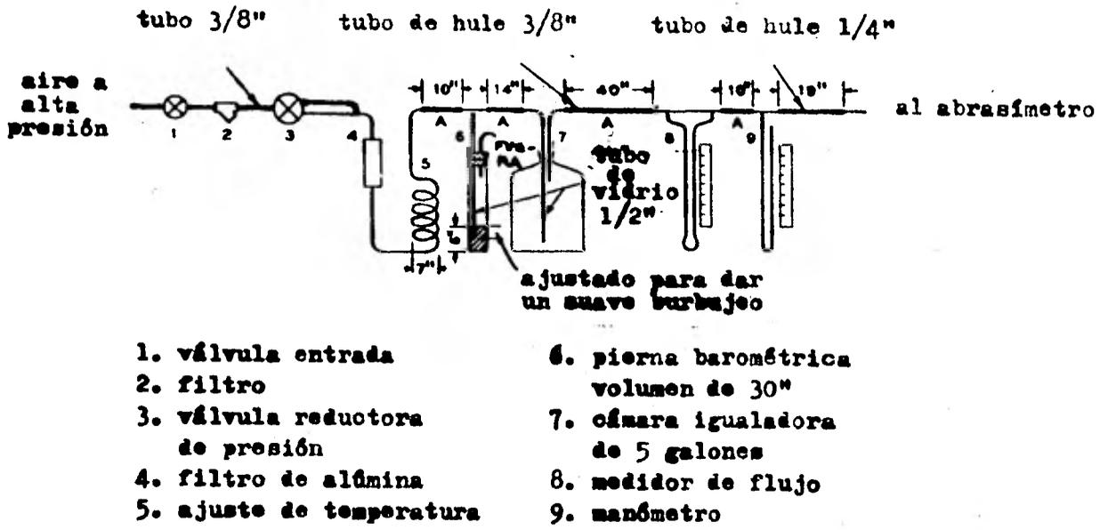
Fig. 3.- Control de aire para la abrasión.
