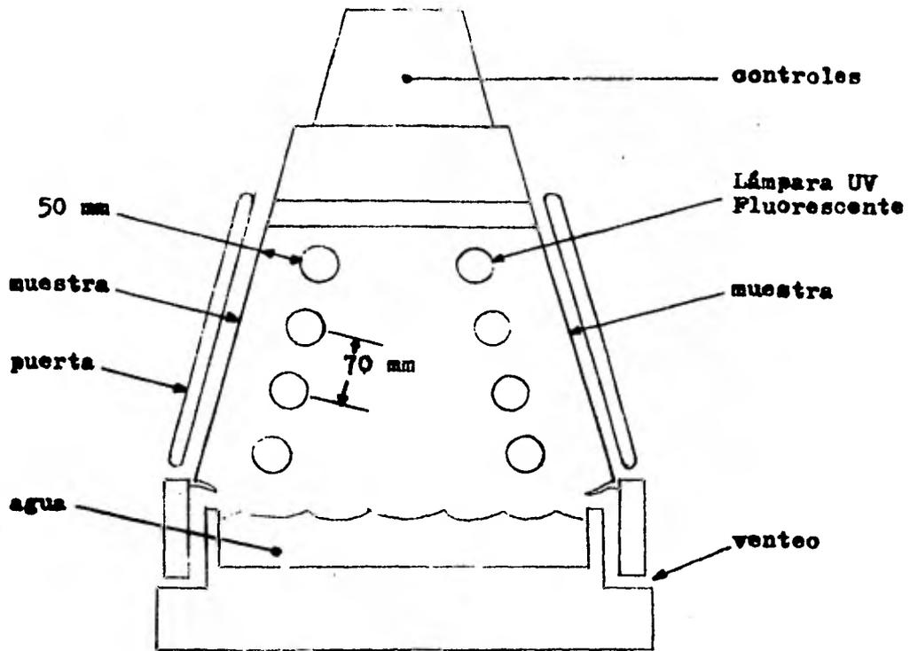
Fig. 6 .- Esquema del aparato.
