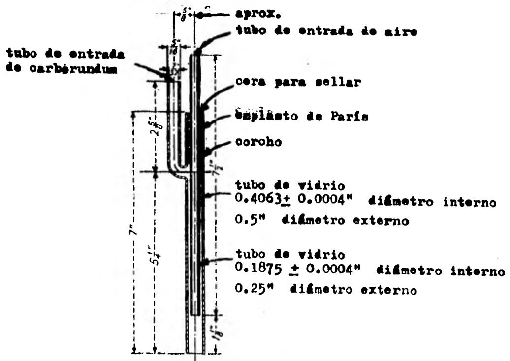
Fig. 4.- Esquema del acoplamiento.
