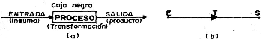
Figura 1.2 Elementos básicos de un sistema: a) Diagrama de bloques. b) Diagrama de flujo de señales.
