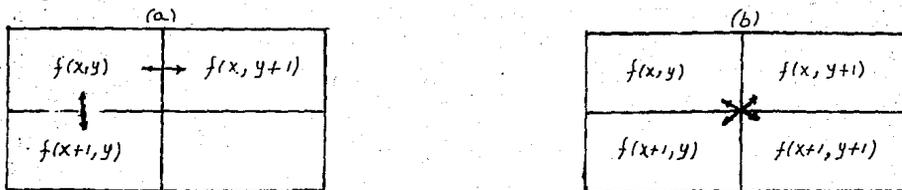
Fig.2.9 Dos procedimientos para calcular un gradiente bidimensional discreto.
