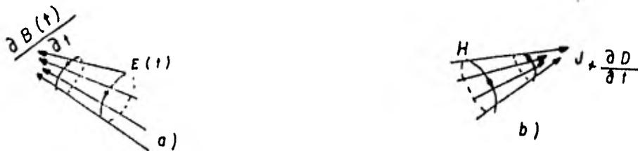
FIG. I.1.— CAMPOS ELECTRICO "a" Y MAGNETICO "b"
