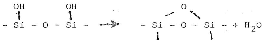
Carman (3) señaló que en la superficie de una masa de SiO<sub>2</sub> amorfo, los átomos de silicio tratan de mantener una coordinación tetraédrica con el oxígeno y por lo tanto tienden a reaccionar con el agua para formar grupos SiOH.
