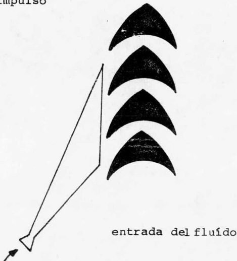
FIG. 4.- Representación de una etapa de impulso o acción mediante una boquilla y un conjunto de hojas.
