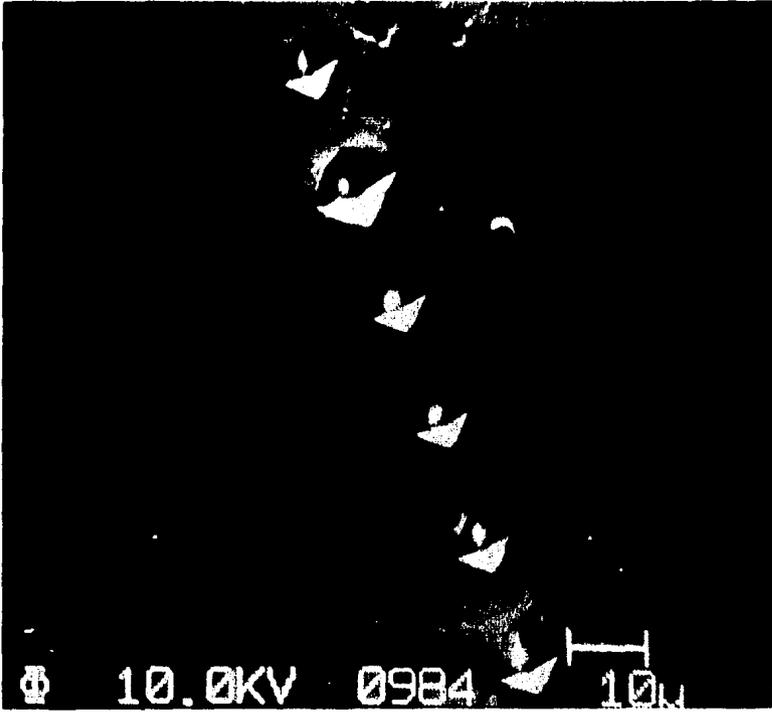
Fig. V.2. Columna de indentaciones para construir el perfil de microdureza, perpendicular a la superficie nitrurada.
