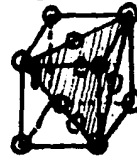
Fig.6 Planos de deslizamiento en un núcleo de aluminio.
