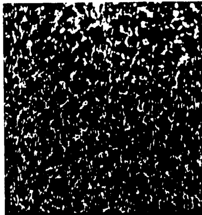
FIG. 50 FUNDICION M, 0.25% inoculante, atacado con reactivo de stead, 14x.
