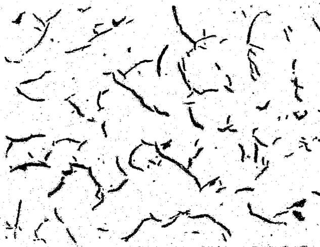
FOTO 4.12 PROBETA 0209, X100, SIN ATAQUE, EN EL CENTRO. GRAFITO TIPO A Y GRANDES ZONAS CON UNA FORMA DE GRAFITO INTERMEDIA ENTRE "A" Y "B".
