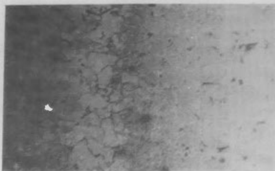
FOTOGRAFIA N° 8 : Acero W-2 templado y revenido a 200°C y 60 min en \varnothing = 31 mm ; ataque con nital 5 ; 100 X ; zona templada; otra vez se encuentra presente la banda de bainita seguida de la zona martensítica.
