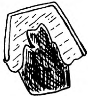
FIG. 12 En este corte, se aprecia el espacio ocupado por la resina.
