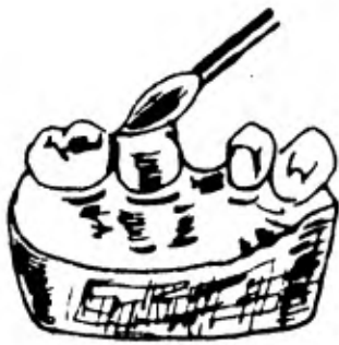
FIG. 9 El modelo de yeso se pinta con separador para resinas.
