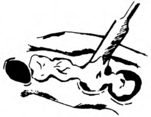
FIG. 10 Se hace una mezcla de resina autopolimerizable, espesa, y se lleva a la "sobreimpresión".
