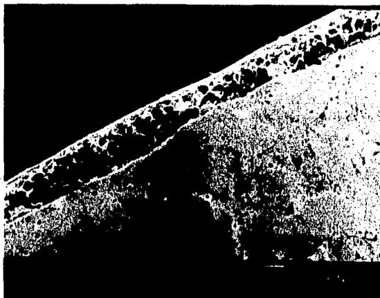
FOTOGRAFIA 1.- Tomada a un cilindro galvanizado 2 horas y 400 °C, el espesor de la capa de difusión es aproximadamente 20 micras.
